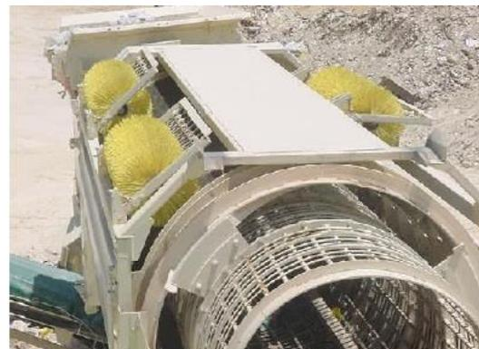
En la alimentación se realiza una criba la cual limita el tamaño de entrada. Se obtienen dos productos limpios de distinto tamaño, medios (10 – 50 mm) y finos (0 – 10 mm). La fracción gruesa con un tamaño de entre 50 – 150 mm continúa por la cinta transportadora hasta la salida, dónde se realiza otro triaje manual para la retirada de rechazos.
