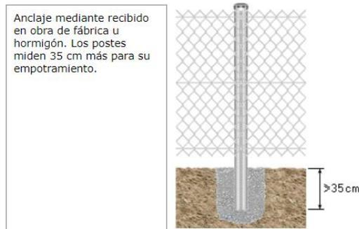
Se medirá por metros lineales realmente colocados, y en el precio se considera incluida la parte proporcional de postes de arriostamiento, postes de esquina, tensores, grapas, etc. y todos los elementos constitutivos del vallado terminado, incluso excavación y relleno de zanja, zapatas de hormigón y reperfilado final del terreno, si es preciso.
