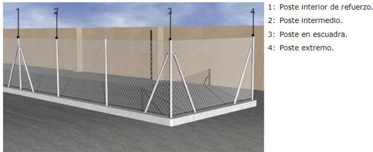
La separación entre postes se fija en 3,5 m. La longitud de anclaje de los postes en las zapatas será como mínimo de 40 cm. En los quiebros y esquinas se dispondrá los oportunos postes de esquina.
